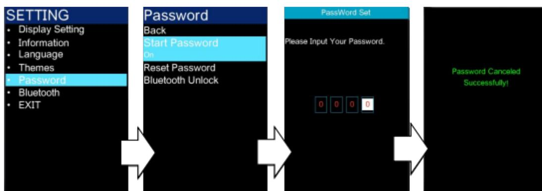
③ Modifier le mot de passe-Lorsque le mot de passe est activé (Start Password statis est activé)
