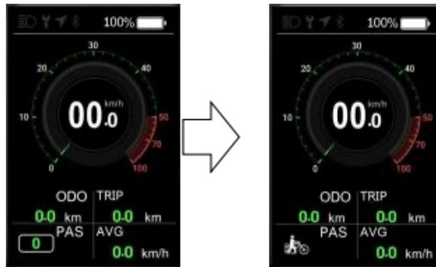
La position vitesse affiche la vitesse de boost et le panneau de boost clignote. En mode boost, la vitesse du véhicule est inférieure à 6 km/h. Lâchez le bouton pour arrêter l'état de boost. Le panneau de boost à l'écran disparaît et l'état du panneau de boost statique est restauré. Sous 5 secondes de suralimentation statique, s'il n'y a pas de bouton, il sera automatiquement réglé sur la vitesse 0.
