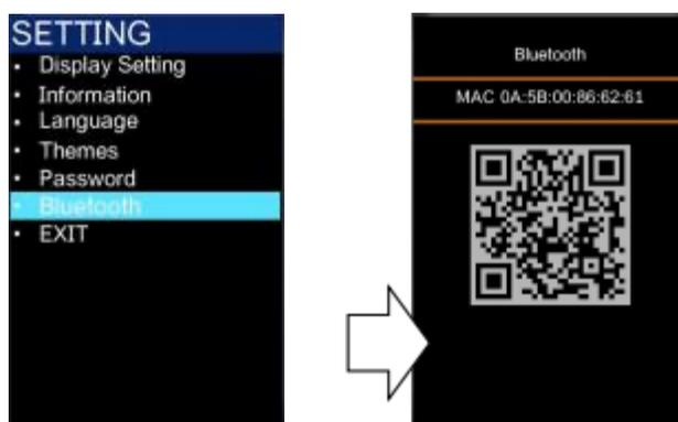
Remarque: La distance de communication entre l'appareil et le Bluetooth du téléphone mobile doit être à moins de 10 mètres.
