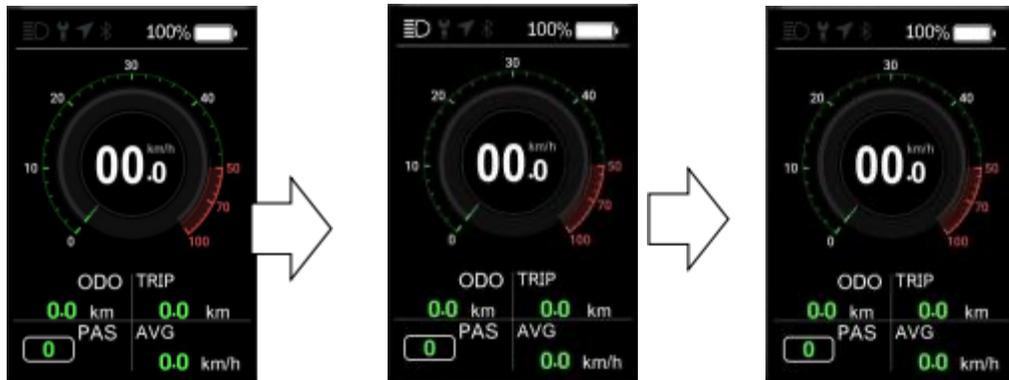
4 Mode de suralimentation Lorsque le véhicule est à l'arrêt, appuyez brièvement sur la touche "-" pour passer à la vitesse 0 et appuyez brièvement sur "
